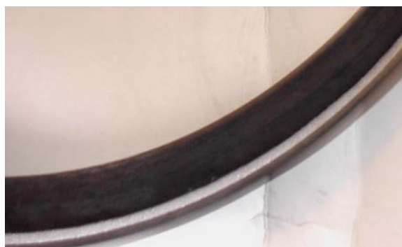
Рис. 14. Износостойкое антифрикционное покрытие на контактной поверхности уплотнительного кольца
