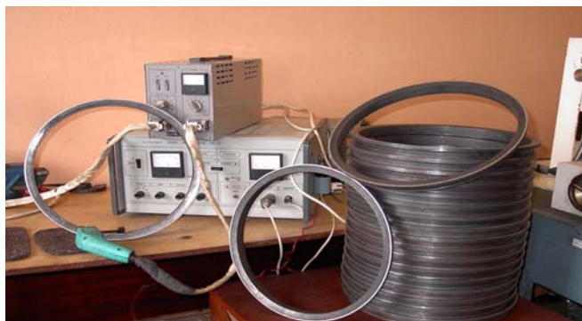
Рис. 14. Износостойкое антифрикционное покрытие на контактной поверхности уплотнительного кольца
