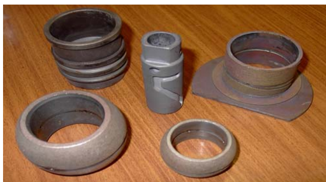
Рис. 13. Некоторые примеры комплектующих летательных аппаратов, восстановленных и упрочненных комбинированным методом ЭИЛ с УЗМ
