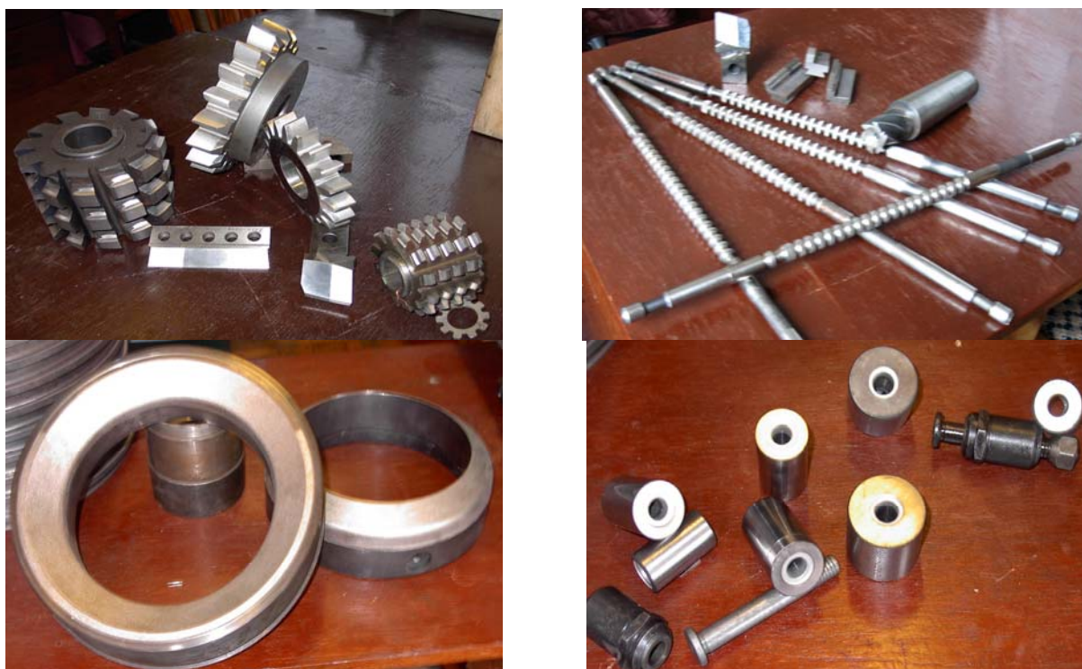
Рис. 15. Восстановленный и упрочненный интегральным методом ЭИЛ с УЗМ металлообрабатывающий инструмент и штамповая оснастка
