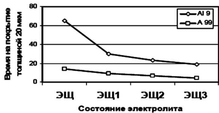
Рис. 23. Сравнительная динамика нарастания толщины покрытий на литейных и деформируемых сплавах алюминия
