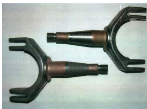
Рис. 13. Некоторые примеры комплектующих летательных аппаратов, восстановленных и упрочненных комбинированным методом ЭИЛ с УЗМ
