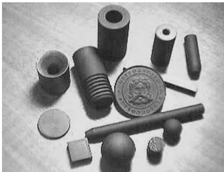
Рис. 4. Образцы изделий сложной формы, изготовленные с использованием особенностей безусадочной технологии
