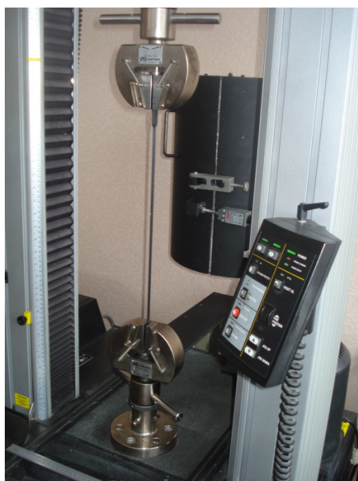
Рис. 11. Испытание на растяжение образцов из оболочки ПИ-трубы
