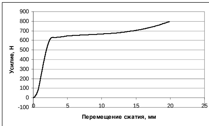
Рис. 2. Усредненная зависимость «усилие (Н)- перемещение (мм), построенной по 3-м диаграммам
