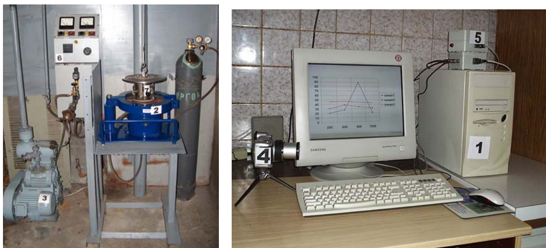
1 - ПВЭМ для сбора и обработки данных; 2- экспериментальный реактор СВС; 3 - агрегат вакуумный ротационный; 4 - цифровая камера; 5 – модуль контроля и диагностики; 6 – пульт управления; 7- устройство для предварительного подогрева
