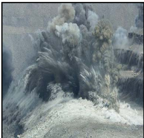
Рис. 4. Взрыв ЭВВ в карьере на РУПП Гранит
