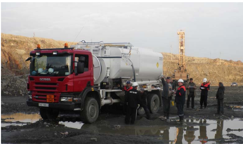
Рис. 2. Загрузка ЭВВ в скважину на РУПП Гранит
