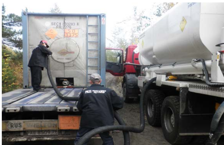
Рис. 1. Загрузка смесительно-зарядной машины «Универсал» компонентами ЭВВ
