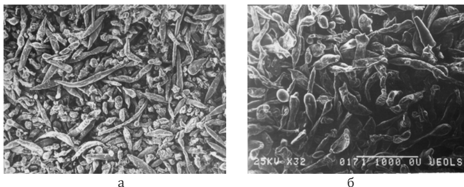
Рис. 2. Характерная форма частиц, полученных центробежным распылением сплава Д16 (-0063+005) \times 32 (а) и сплава AL+10% мас. Ni (-0063+005) \times 22 (б)
