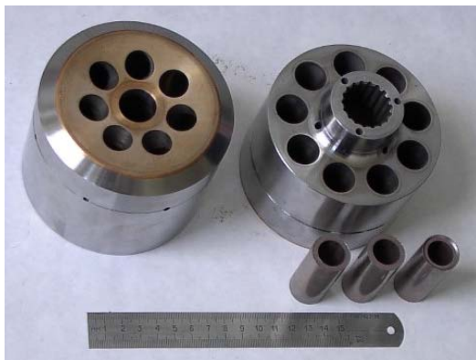
Рис.13. Порошковый композиционный антифрикционный материал и технология его нанесения на рабочие поверхности (торцовая распределительная и поверхности цилиндров) блока аксиально-поршневых насосов и гидромоторов серии «А»
