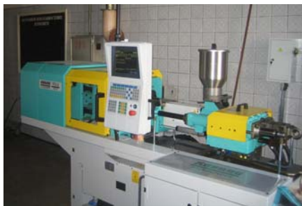
Рис.20. Универсальная машина ALLROUNDER 170 U 150 - 70 инъекционного формования пластифицированных смесей порошков керамики, металлов и сплавов
