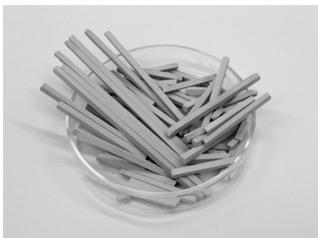
Рис. 21. Общий вид гранулированных носителей, использованных для приготовления катализаторов дегидрирования легких углеводородов
