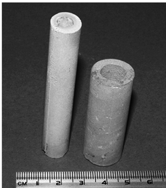
Рис. 20. Пористые керамометаллические трубки – носители для каталитических мембран.
