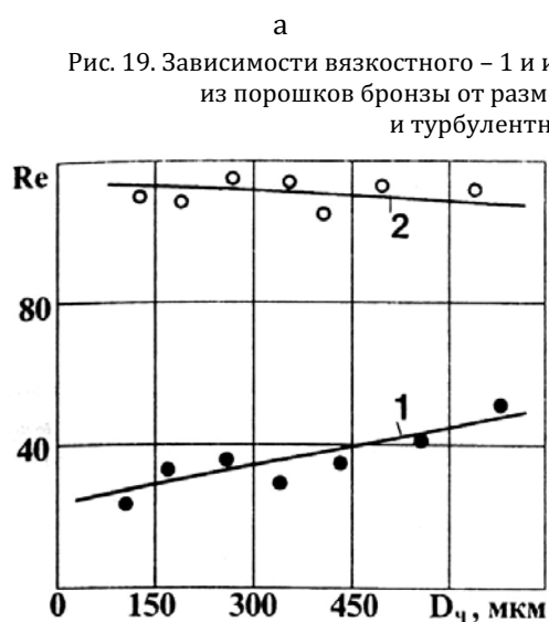
Рис. 20. Зависимость критических чисел Рейнольдса при переходе от ламинарного режима к переходному – 1 и от переходному к турбулентному – 2 от размеров частиц ППМ из порошков бронзы
