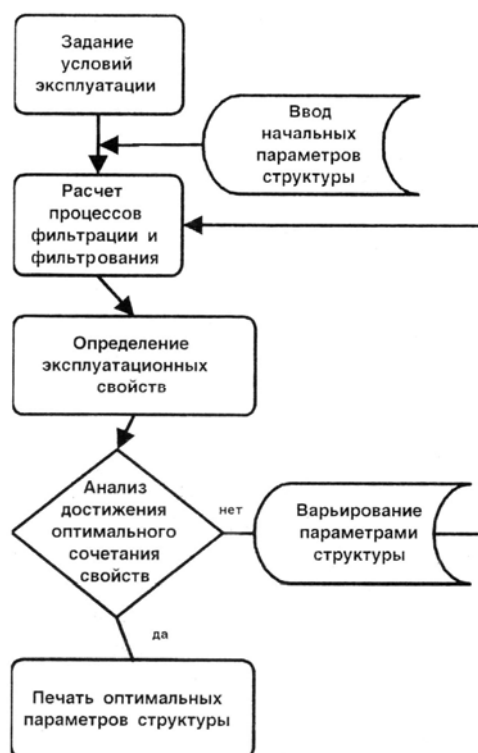
Рис. 27. Блок-схема процесса определения оптимального порораспределения ППМ
