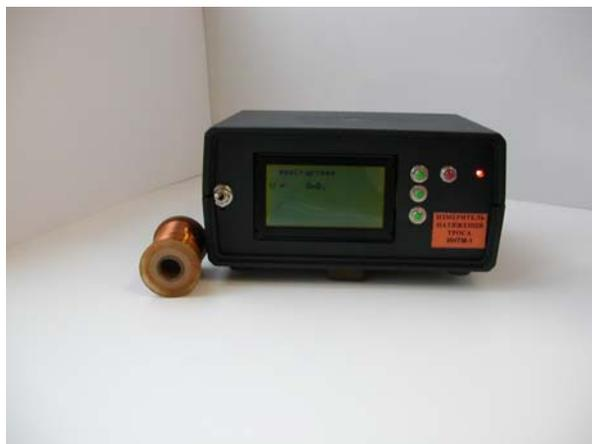
*Предназначен для бесконтактного измерения натяжения стального ферромагнитного троса на основе анализа вторичной э.д.с. проходного преобразователя, через который проходит трос, по предварительно установленным калибровочным зависимостям*
