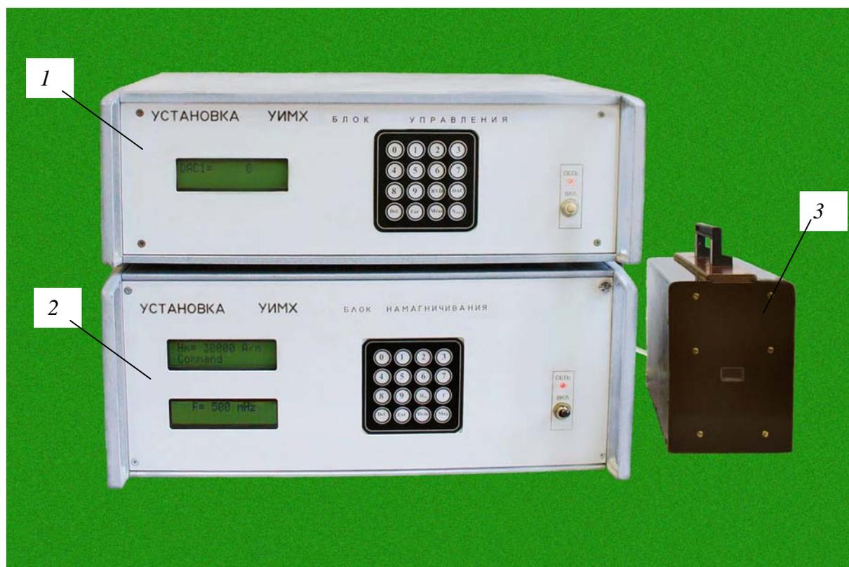
1 – блок управления; 2 – блок намагничивания; 3 – преобразователь
