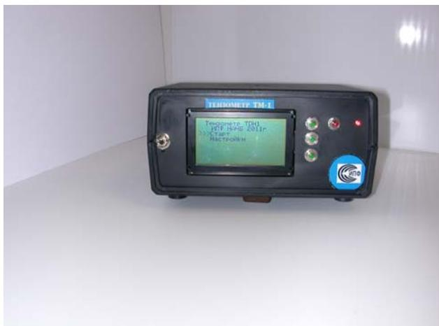
*Предназначен для измерения деформации различных конструкций, в качестве тензочувствительного элемента применяется стальной трос (или проволока), закрепленный на этой конструкции, принцип действия основан на взаимосвязи магнитных параметров ферромагнетика с его деформацией*
