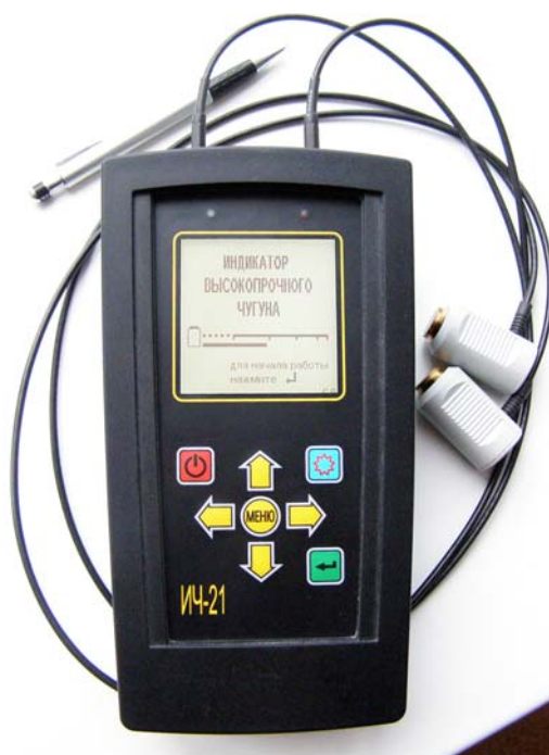
Рис. 2. Индикатор высокопрочного чугуна ИЧ-21
